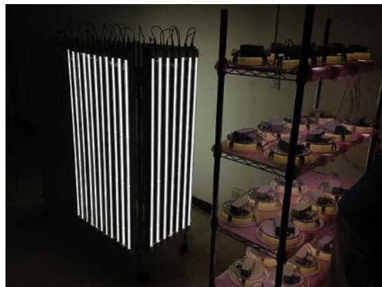
製造した全品を8時間以上の点灯試験後に出荷
